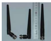
屈曲型スリープアンテナ G=2dBi
