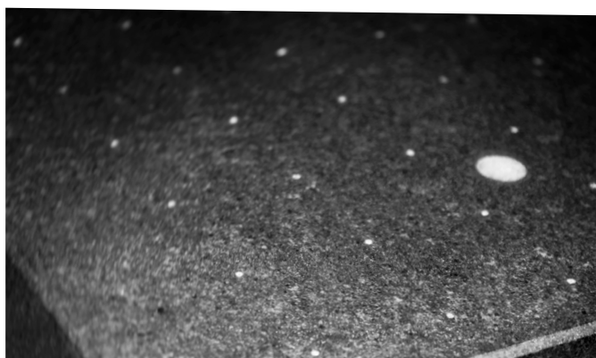
高精度1um花崗岩真空吸着テーブル
