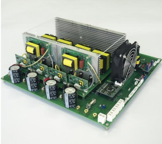
DLLC068-4804-1 はパワーアシストテクノロジーが開発した LLC 用漏洩磁束トランスを搭載の高効率 4kW 出力 LLC コンバータです。
