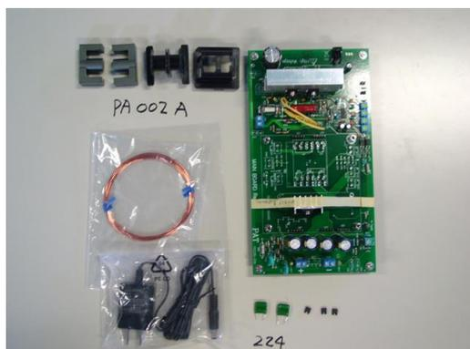
パワーアシストテクノロジーの LLC 共振電源実験キットは、部品実装済みのハーフブリッジ型の LLC コンバータ基板にトランス材料一式、共振用コンデンサ、制御回路駆動用の AC アダプタなどがセットになった LLC 入門用キットです。市販の LLC 制御用 IC を使い、デッドタイムや動作周波数設定がポリウムで調整できるようになっています。
