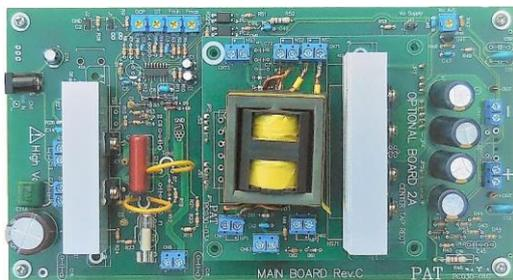
LLC 共振電源実験キットをより実用レベルにパワーアップしたキットです。
